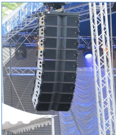
Abbildung 67 Beispiele: Line Array für Zentralbeschallung (links) und Kompaktlautsprecher für Dezentralbeschallung (rechts)
